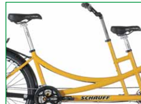
DTD-System: Ermöglicht hinten einen größeren Fahrer/Fahrer als vorne
