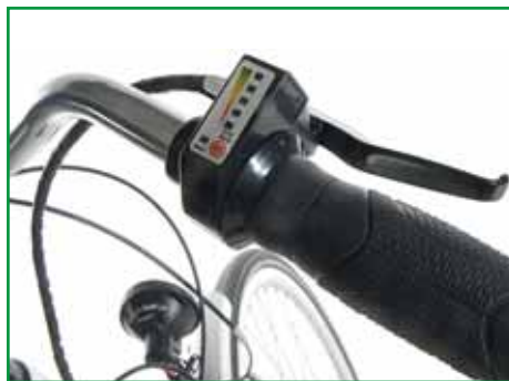
Schachner Drehgriff mit LED-Anzeige
