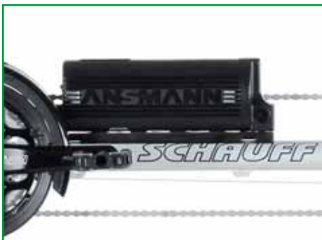
Tiefer Schwerpunkt: Speise-Akku auf Kielrohr
