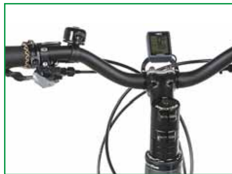
Schaltzentrale mit Tachofunktion
