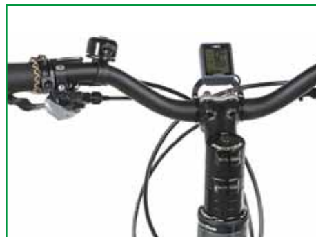
Schaltzentrale mit Tachofunktion
