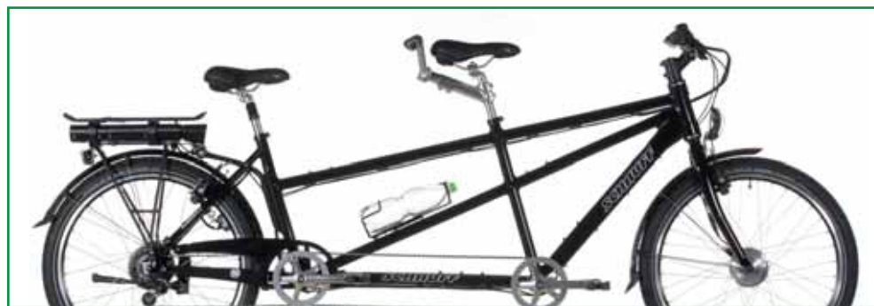
Optionen: NuVinci N360 Nabenschaltung mit Ansmann Frontantrieb und Bremsen Magura HS33R, XXL-Trinkflaschenhalter
