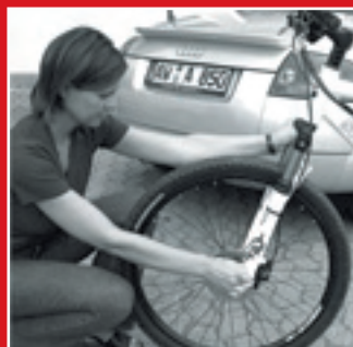
Pedale einklappen, Vorderrad-Schnellspanner öffnen, Vorderrad entnehmen ...
