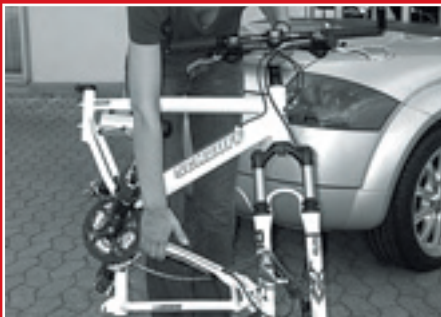
... Lenker/Gabel um 90° drehen, ... Hinterbau einschwenken, Rahmen zusammenklappen ...
