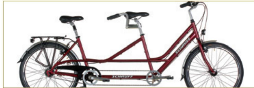
Option: bei Nabenschaltungen Freilaufrettlager hinten (Abb.) und/oder vorne, Kettenkasten hinten
