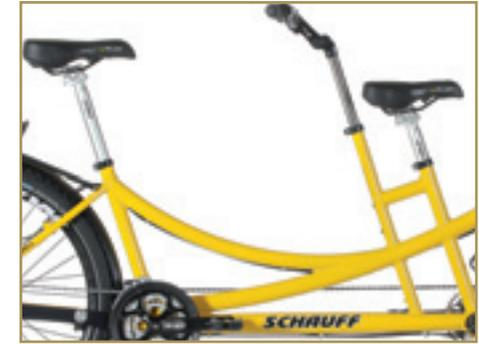
DTD-System: Ermöglicht hinten einen größeren Fahrer/Fahrer als vorne
