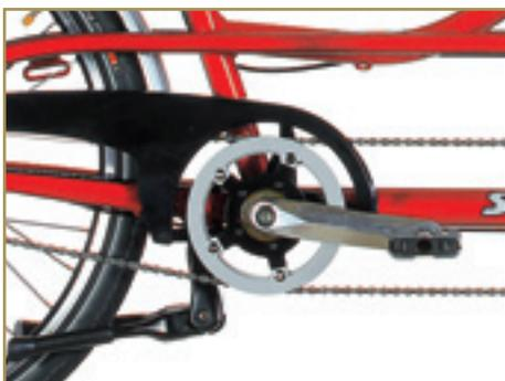
Optionen: Freilaufretlager, Kettenkasten hinten
