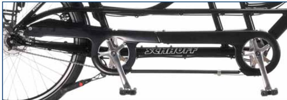
Option: Kettenkasten komplett geschlossen
