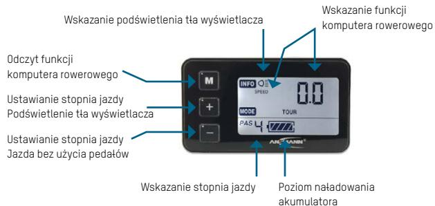
Bezpośrednio po włączeniu napędu przyciskiem/przełącznikiem na akumulatorze sterownik wyświetlacz ustawia automatycznie stopień jazdy 2. Przy-
