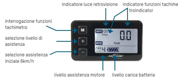
Quando il Sistema viene acceso accendendo la batteria, il livello di assistenza si setta automaticamente al livello 2. Premendo i tasti "+" "-" è possibile modificare l'assistenza del motore dal livello zero (nessuna assistenza) o da 1 al livello massimo 6.
