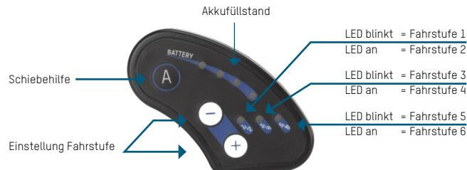
Direkt nach dem Einschalten des Antriebs über die Taste / den Schalter am Akku wird über die Displaysteuerung automatisch die Fahrstufe 2 eingestellt. Mit den Tasten " - " und " + " kann zwischen den Fahrstufen 0 (keine Unterstützung) und 1 – 6 gewählt werden. Je nach eingestellter Fahrstufe wird eine andere Motorunterstützungsgeschwindigkeit erreicht (Tempomatfunktion). Durch Drücken der Taste " A " wird die Schiebehilfe aktiviert; diese ist nur solange aktiv, solange die Taste gedrückt bleibt.
