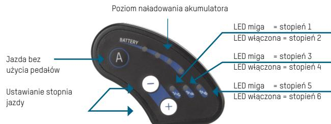
Bezpośrednio po włączeniu napędu przyciskiem/przełącznikiem na akumulatorze sterownik wyświetlacza ustawia automatycznie stopień jazdy 2. Przyciskami „-” i „+” można wybierać stopnie jazdy 0 (bez wspomagania) oraz 1 – 6. Zależnie od nastawionego stopnia jazdy osiąga się różne prędkości jazdy wspomaganej przez silnik (funkcja tempomatu). Naciśnięcie przycisku „A” załącza pomoc w sposób taki, że pozostaje ona aktywna, dopóki przycisk jest naciśnięty.
