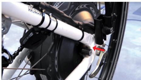
Korrekte Lage der Drehmomentabstützung am Pedelec
