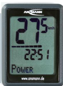
En appuyant sur le bouton inférieur (U) à plusieurs reprises, le niveau du soutien Pedelec peut être changé (inférieur au niveau POWER), en position OFF.
