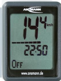
Durch Drücken der oberen Taste (0) schalten Sie die Pedelec-Unterstützung ein und können diese von der Stufe Eco/ Eco+/ Normal/ Normal+/ Power, durch jeweiliges Drücken der Taste (0), hochschalten.
