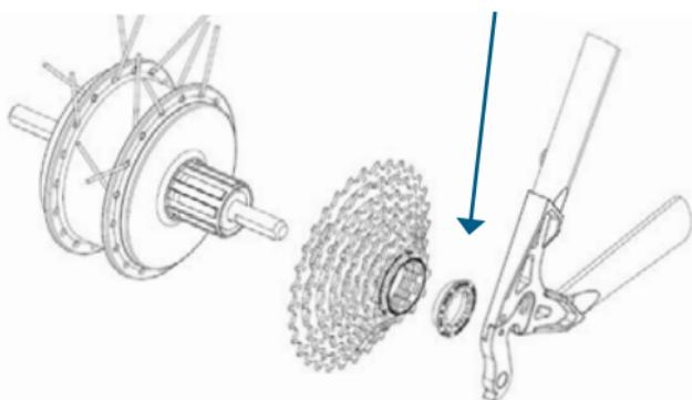
Bei der Befestigung des Laufrades ist darauf zu achten, dass das Formteil der Drehmomentabstützungen (beidseitig) nach unten gedreht ist, damit die Achse passend in Gabel (Vorderradmotor) / Ausfallende (Hinterradmotor) sitzt. Das Anzugsmoment der Achsmuttern beträgt 25Nm.
