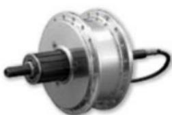
**MOTORE POSTERIORE RM5.0 36V/ 250W** per telai mis. Posteriore 135mm, incluse parti di assemblaggio asse e cavo motore, fino a 10 velocità cassetta, possibile assemblaggio freni a disco.
