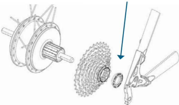
Durante il fissaggio del rotore, assicurarsi che la parte sagomata del supporto torsione (entrambi i lati) siano girati verso il basso, in modo che gli assi siano posizionati in maniera precisa dentro alla forcella (motore anteriore) o dentro al carro posteriore (motore posteriore). La torsione di fissaggio dei dadi è di 25Nm.
