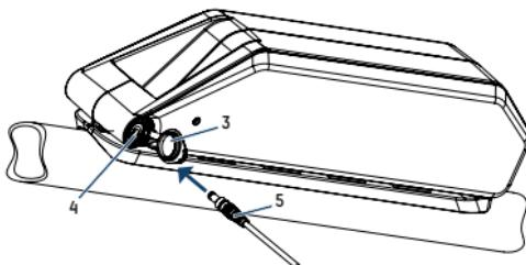
Per rimuovere la batteria a portapacchi della bicicletta, aprire anzitutto la chiavi di bloccaggio girandola in senso anti-orario (1), poi spingere la batteria fuori dal suo involucro (casing/housing). Quando la batteria viene inserita nella sua custodia nuovamente, girare la chiave di sicurezza in senso orario in modo da fissare la batteria ed evitare che cada mentre si pedala o che venga rubata.
