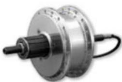
**HINTERRADMABENMOTOR RM5.0 36V / 250W** für Fahrradrahmen mit 135mm Hinterbaubreite, inklusive Achsbefestigungen und Anschlussleitung, für bis zu 10-fach Steckkassette, Anbaumöglichkeit für Bremsscheibe
