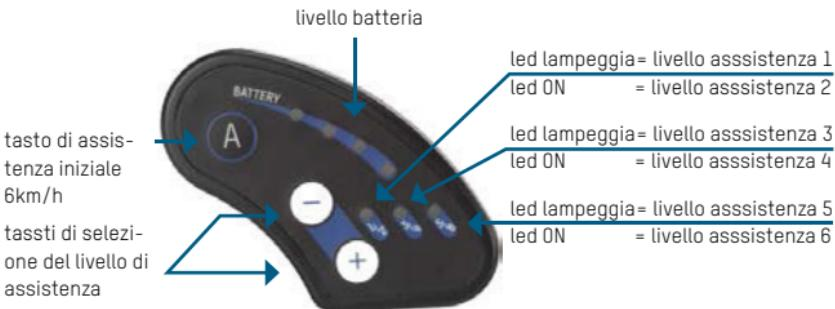
Quando il Sistema viene acceso accendendo la batteria, il livello di assistenza si setta automaticamente al livello 2. Premendo i tasti “+” “-” è possibile modificare l’assistenza del motore dal livello zero (nessuna assistenza) o da 1 al livello massimo 6. In base al livello prescelto si avrà una differente velocità dal motore. Premendo il tasto “A” il motore da assistenza fino a 6km/h senza pedalare (funzione di assistenza iniziale) mentre si continua a premere il tasto.
