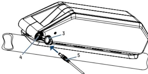
Bei dem Flachakku drehen Sie den Schlüssel entgegen dem Uhrzeigersinn [1.], danach schieben sie den Akku nach hinten aus seiner Halterung [2.]. Nach dem erneuten Einschieben des Akkus in den Akkuschacht müssen Sie den Akku über das Schloss verriegeln (Schlüssel in Uhrzeigersinn drehen) um ihn gegen Herausfallen zu sichern (auch Diebstahlschutz).
