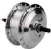
**MOTORE FRONTALE FM4.0 36V/250W** per forcelle misura 100mm, incluse parti di assemblaggio asse e cavo motore, possibile assemblaggio freni a disco.
