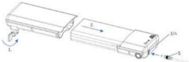
Öffnen Sie zum Laden mit Hilfe der Verschlusskappe [3] den Zugang zur Ladebuchse [4] und schließen Sie dort den Ladestecker [5] des Ladegerätes an.
